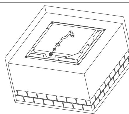
Depois de controlar a correcta fixação do chassis, remover o travamento em cruz. Ligar o flexível ao tubo de alimentação de água.
