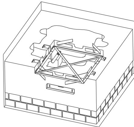
Abrir as alhetas laterais e introduzir o chassis no corte, nivelando-o. Fazer passar o tubo de alimentação através de um dos rasgos existentes no chassis.
