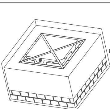
Bloquear o chassis com argamassa ou cavilhas (não incluídas). Rebocar o tecto de maneira a que o perfil do revestimento fique ao nível do bordo inferior do chassis.
