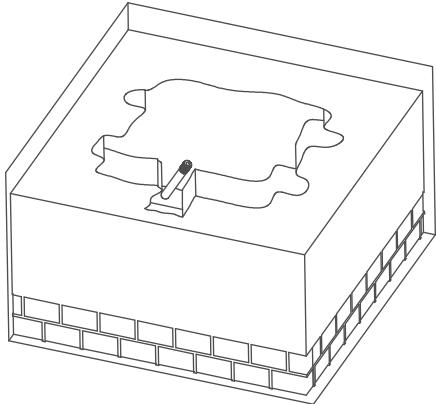
Prever a existência de um corte, com a profundidade mínima de 85 mm e com as dimensões necessárias ao alojamento do chassis e do tubo de alimentação de água.
