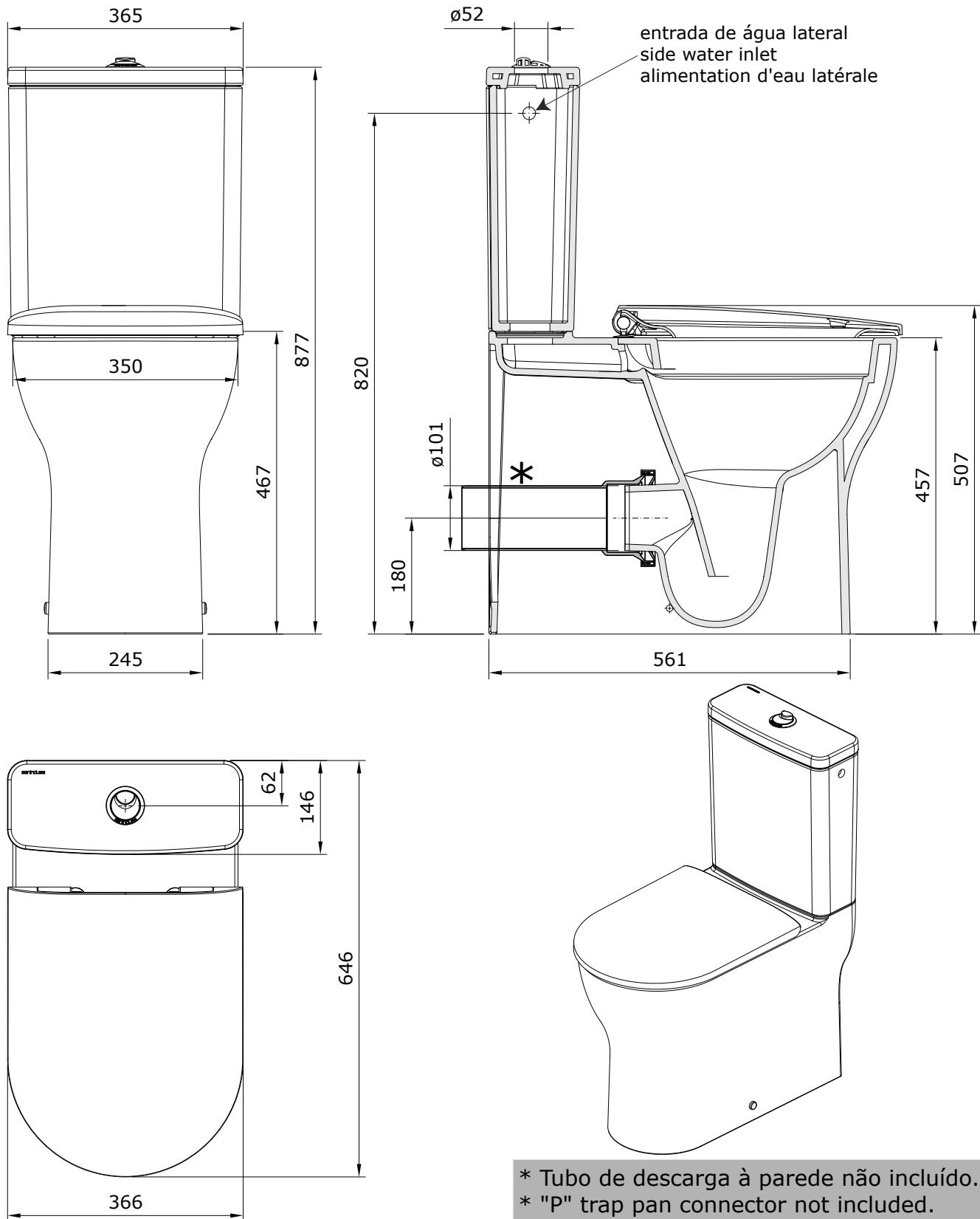
\* Tubo de descarga à parede não incluído.
