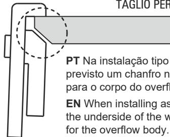
**PT** Na instalação tipo encastrar por cima deve ser previsto um chanfre no plano inferior da bancada, para o corpo do overflow.
