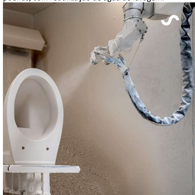
Imagem 10: Linha de produção cerâmica – Robô de Vidragem
